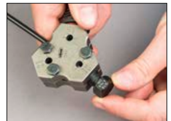
DIN flaring process
