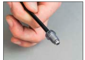
DIN flaring process
